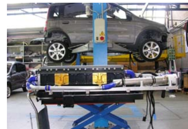
Fasi di montaggio della Panda Hydrogen © CRF
